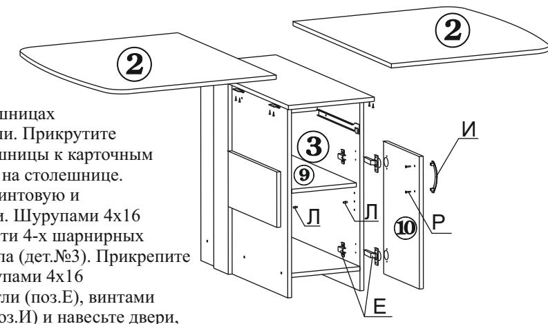
1.4. В отверстия на дополнительных столешницах вставьте полкодержатели. Прикрепите дополнительные столешницы к карточным петлям, закрепленным на столешнице. Закройте заглушками винтовую и эксцентриковую стяжки. Шурупами 4x16 закрепите ответные части 4-х шарнирных петель на боковине стола (дет.№3). Прикрепите к двери (дет.№10) шурупами 4x16 четырехшарнирные петли (поз.Е), винтами M4x20 (поз.Р) ручку (поз.И) и навесьте двери, закрепив петли на ответные части крепежными винтами.
