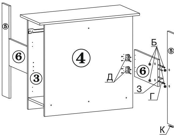
1.3. На нижних торцах выдвинных боковин стола (дет.5) закрепите наконечники (поз.К) с помощью гвоздей. В отверстия в боковинах и монтажных планок (дет.№5,6) вставьте эксцентрики (поз.Б). Обратите внимание: стрелка на эксцентрике должна быть направлена к торцу детали.
