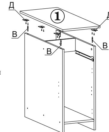
1.2. В отверстия на столешнице (дет.№1) закрутите штоки эксцентриков (поз.В), шурупами 4 x16 закрепите картонные петли (поз.Д). Опустите столешницу на боковины так, чтобы штоки эксцентриков вошли в отверстия в торцах боковин и царге. Поверните эксцентрики на боковинах и царге на 180 град. по часовой стрелке.
