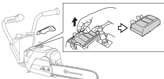
Для более тщательной чистки фильтр следует помыть в воде с мылом.
