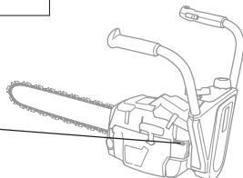
Газ запуска: Положение комбинации съятнения/газ запуска получим когда установим ручку в положение съятнения.
