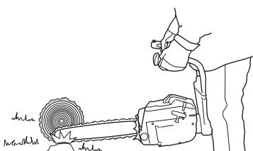
Выполняйте пиление от начала и до конца с верхней части бревна. Попробуйте не коснуться грунта в момент окончания резки. Работайте на полном газу, но будьте готовы, что цепь может коснуться грунта.
