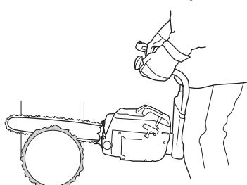
Существуют методы валки деревьев с полотном, меньшим диаметром ствола. Однако эти методы достаточно опасны, т.к. область отдачи полотна входит в контакт с предметом.
