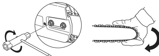
При установки новой цепи следует часто проверять ее натяжение, пока цепь не приработается. Регулярно проверяйте натяжение цепи. Регулярно проверяйте натяжение цепи. Правильно натянутая цепь обеспечивает высокое качество пиления и дольше служит.
