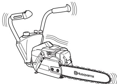
Проверьте, чтобы виброгасящие элементы были надежно закреплены на блоке двигателя и ручках.
