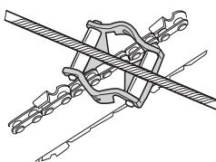
См. указания в разделе Технические данные, относительно того, какие данные действительны при затачивании цепи Вашей моторной пилы.
