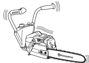
Система виброгашения машины снижает уровень вибрации, передаваемый от двигателя или режущего оборудования на ручки машины. Корпус моторной пилы, включая пильный механизм, висит на ручках, отделен от ручек виброгасящими элементами.
