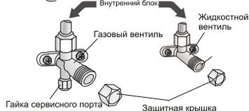
1. Отвинтите и снимите крышку из трехходового или четырехходового клапана.
