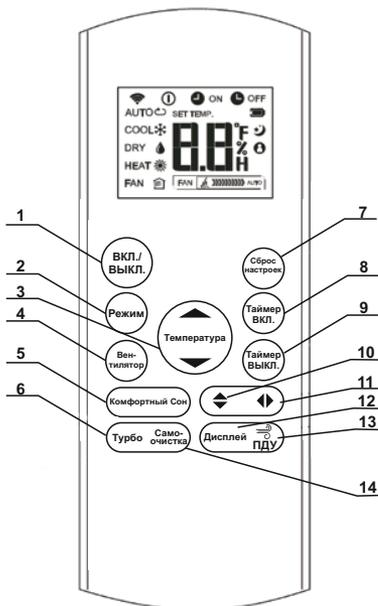
**1 - Кнопка ВКЛ./ВЫКЛ.** Кнопка вкл./выкл. предназначена для включения и выключения кондиционера
