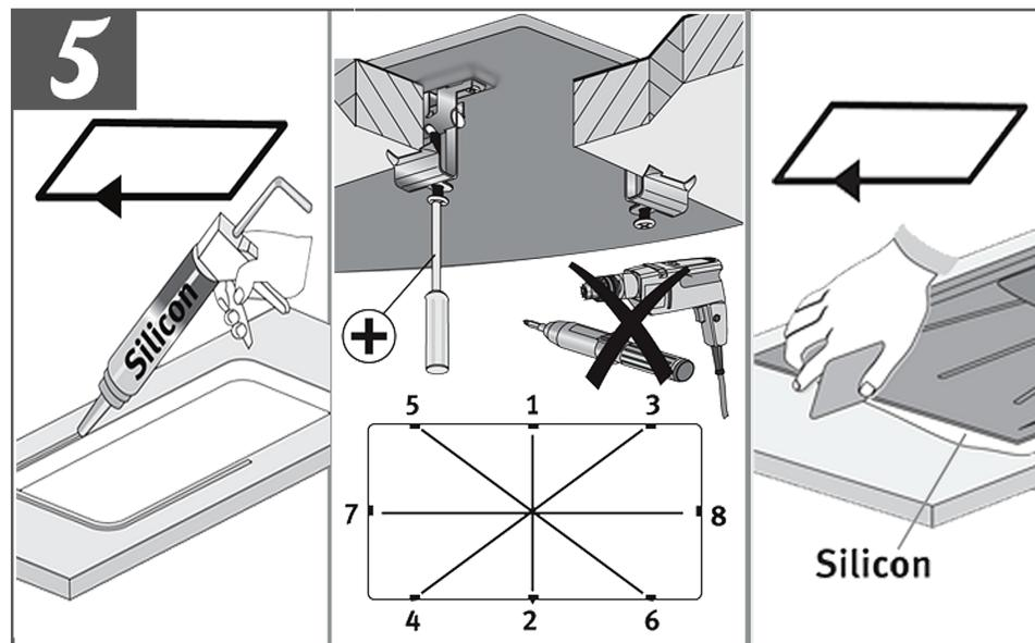
5. После того как герметик затвердеет (если герметик использовался при установке композитной мойки), приступить к монтажу санитарно – технической арматуры.
