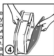
5. Установите переднюю крышку обратно (убедитесь, что она в правильном положении, как указано по стрелке) и нажмите, чтобы крышка встала на свое место. Поверните два фиксирующих рычага по часовой стрелке.
