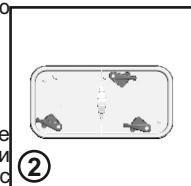
3. Осторожно извлеките рамку фильтра и уберите пыль с помощью ткани. Не используйте воду для очистки фильтра.
