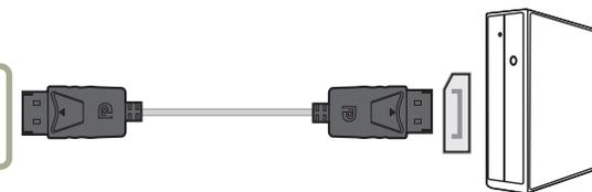
— Рекомендуется использовать кабель DP длиной до 1,5 м. Использование более длинного кабеля может повлиять на качество изображения.
