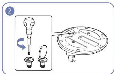
Открутите соединительный винт в нижней части подставки.
